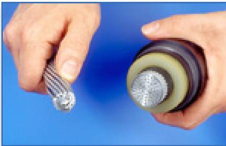
Alors que les conducteurs électriques sont « nus » en aérien, ils ont besoin d'un isolant spécifique en souterrain. Il s'agit de matériaux synthétiques (polyéthylène ou polyéthylène réticulé) dont l'épaisseur augmente avec la tension.
